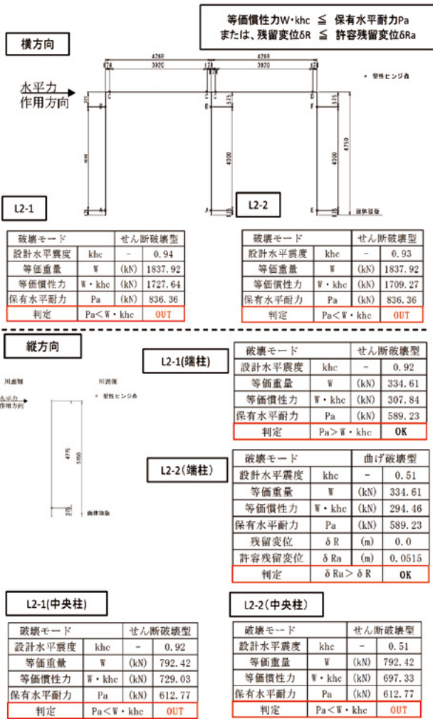
図-6 門柱の解析モデル及び解析結果
