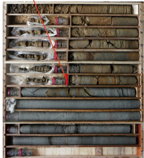
写真-1 ボーリングコア(B-2)によるすべり面の推定
