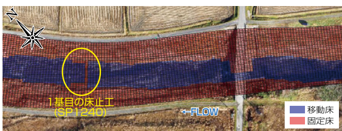
図-7 移動床と固定床の設定(床止工1基)
