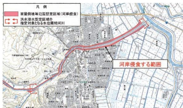
図-8 洪水時家屋倒壊危険ゾーン図
