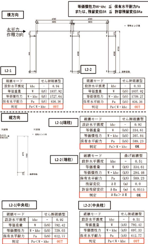
図-6 門柱の解析モデル及び解析結果
