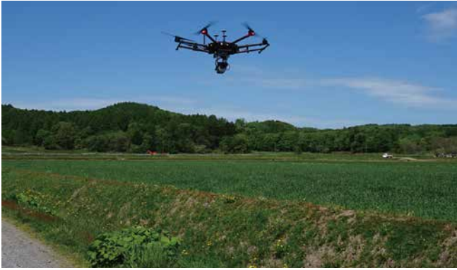
写真-5 UAVレーザ計測状況
