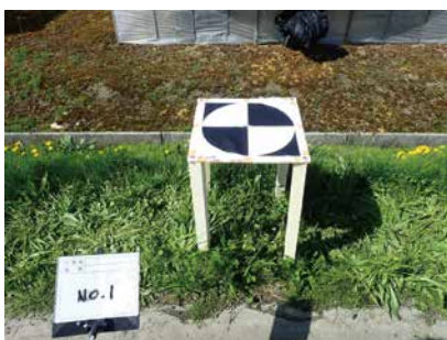
写真-6 標定点の設置
