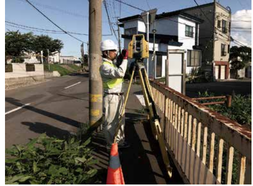
写真-1 地上レーザ計測
